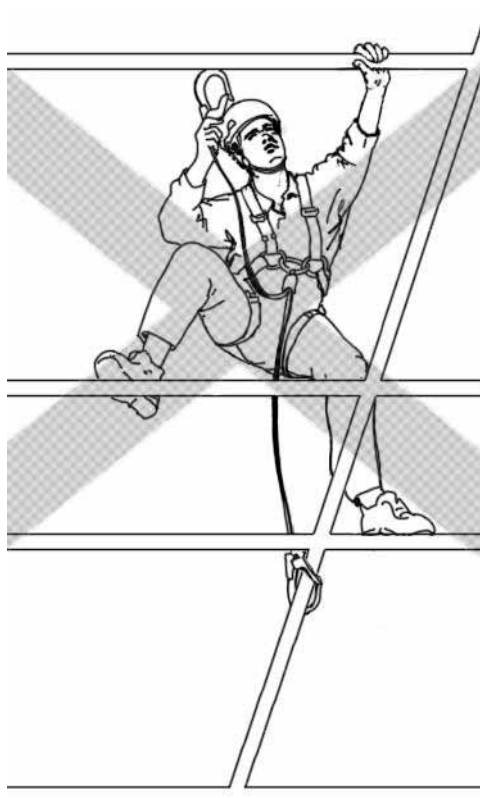
Rysunek Q.3 – Wpięcie lonży stanowiskowej (lub pętli stanowiskowej) w taki sposób, że może zsunąć się podczas upadku, zwiększa długość potencjalnego lotu
