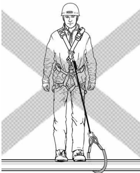
Rysunek Q.2 – Podnoszenie pętli stanowiskowej z jej normalnej pozycji zawieszenia zwiększa potencjalną długość lotu
